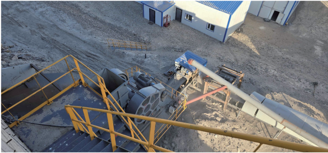
① 작업시즌 채굴하여 야적되어 있는 채굴광석이 파쇄시설을 통해 잘게 해체된 후 선광장으로 이동
